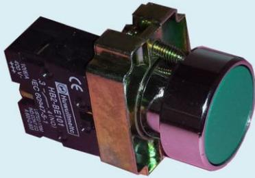
Pulsadores eléctricos, metálicos, usado en circuitos eléctrico para el control de automatismos. El montaje se realiza mediante taladro de diámetro 22mm.
