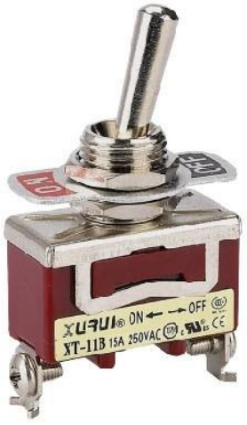
• 单极单投型 SPST ON-OFF XT-11B
